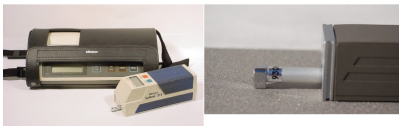
Figura 26. Instrumento de aspereza de superficie de tipo de contacto
