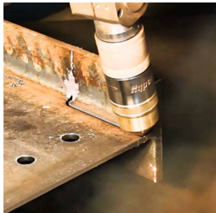
Figura 7. Corte controlado de viga
