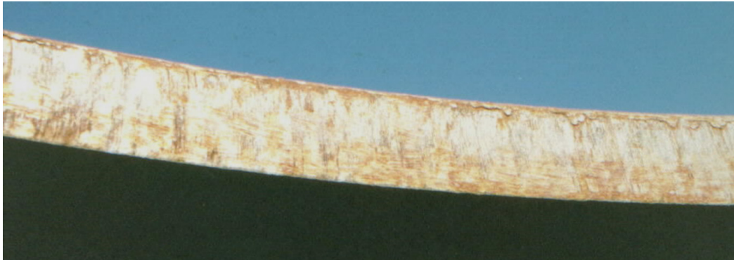
Abbildung 12. Beispiel einer Schnittkante eines reduzierten Trägerprofils
