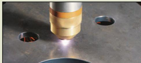
La tecnologia al plasma ad alta definizione allinea e concentra l'arco al plasma, migliorando la stabilità e l'energia dell'arco per una precisione di taglio più potente.
