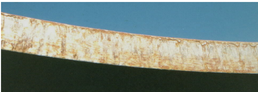
Figura 12. Ejemplo de un borde cortado de RBS
